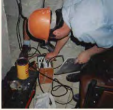
Görüntü 14. Yer ile yapının deprem öncesinde davranışını belirlemek için yapılan yer-yapı jeofiziği çalışmalarından birkaç örnek. Yukarıda çalkalanma(rezonans) ölçümü, ortada yer ıslaklığı için elektro çekimi, aşağıda beton niteliği için ultrason.
